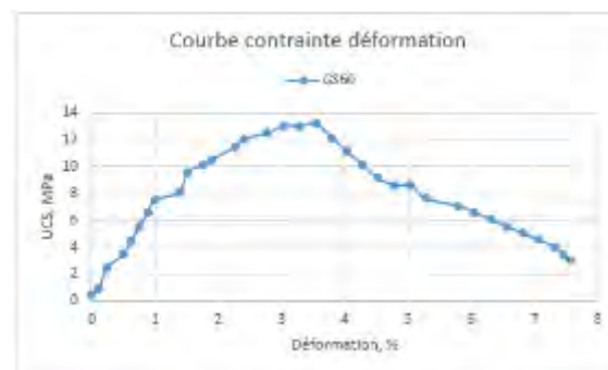
Figure 9. Exemple de courbe contrainte déformation pour un échantillon GS60 de béton écologique après 28 jours de durcissement.
