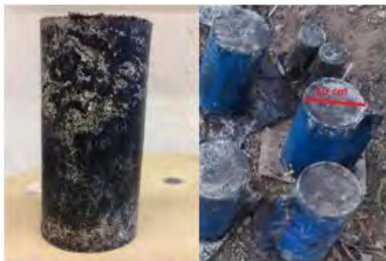
Figure 5. Echantillons des bétons écologiques (GS) à base des déchets plastiques avant et après démoulage.
